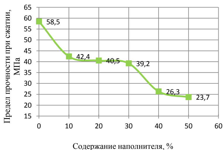
Рис. 4. Влияние содержания наполнителя и пластифицирующей добавки ViscoCrete®-3088 (0,8 %) на прочность декоративного мелкозернистого бетона в возрасте 28 суток
